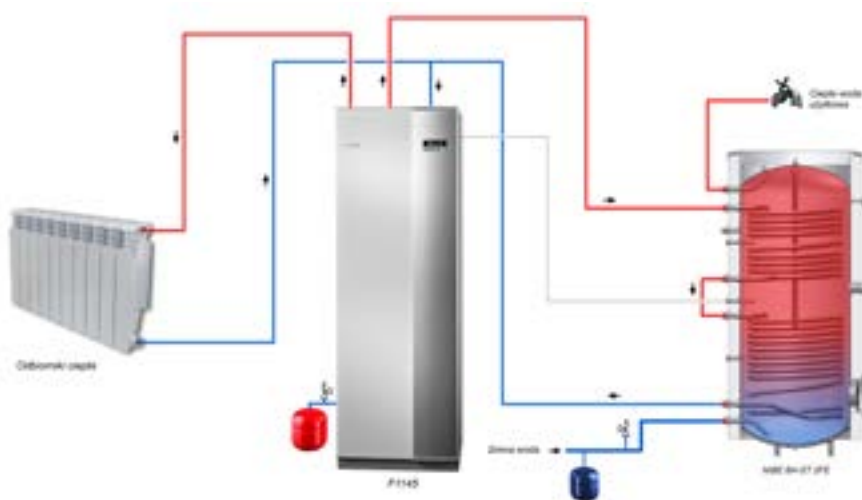
Przykładowy schemat instalacyjny z zasobnikiem NIBE BA-ST 2FE
